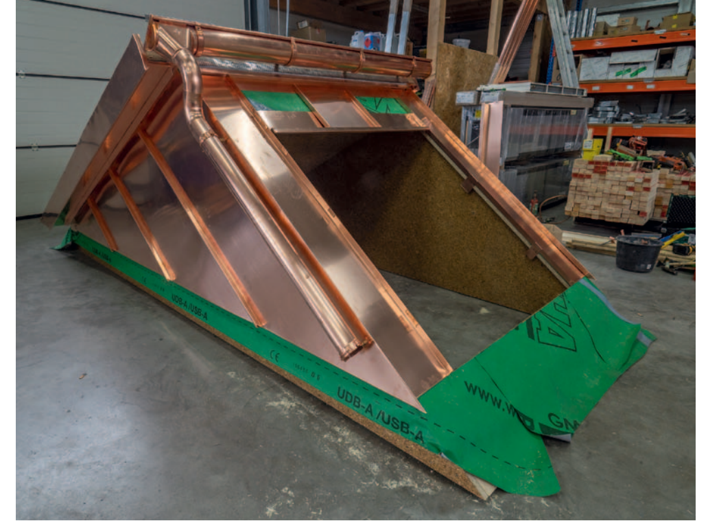
▲ Eine von insgesamt zwölf Gauben steht hier in der Werkstatt für den Abtransport zum alten Amtsgericht bereit
