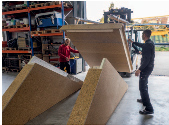
▲ In der Werkstatt wurden die durchnummerierten Bausatz-Elemente in der richtigen Reihenfolge zusammengefügt
