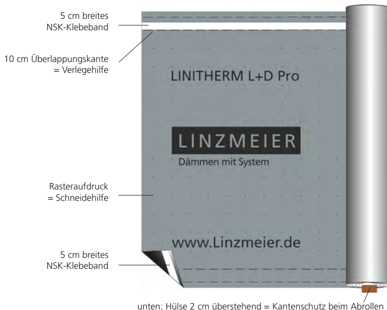
Verlegung allgemein – Verklebung nass in nass; beide Liner abziehen und gut andrücken - ggf. Rolle oder ähnliches verwenden.
