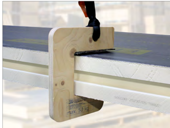
2. Hebehilfe mit der Kranschleufe nach oben auf die Plattenlängskanten aufstecken. 2 Stück pro Plattenseite im Abstand von ca. 3–4 m.
