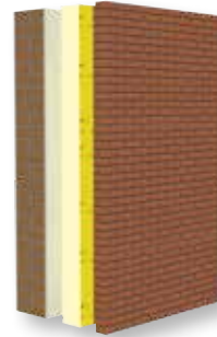
Kerndämmung im zweischaligen Mauerwerk
