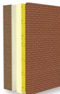
Tepelná izolace sendvičového zdiva
