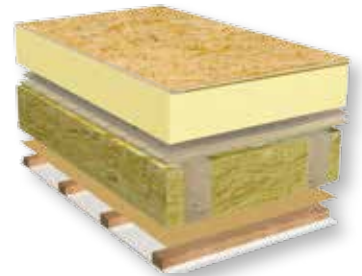
LINITHERM Dachbodenelement P OSB bzw. P OSB Plus LINITHERM L+D-Folie Holzschalung Mineralfaserdämmung zwischen den Sparren raumseitige Bekleidung
