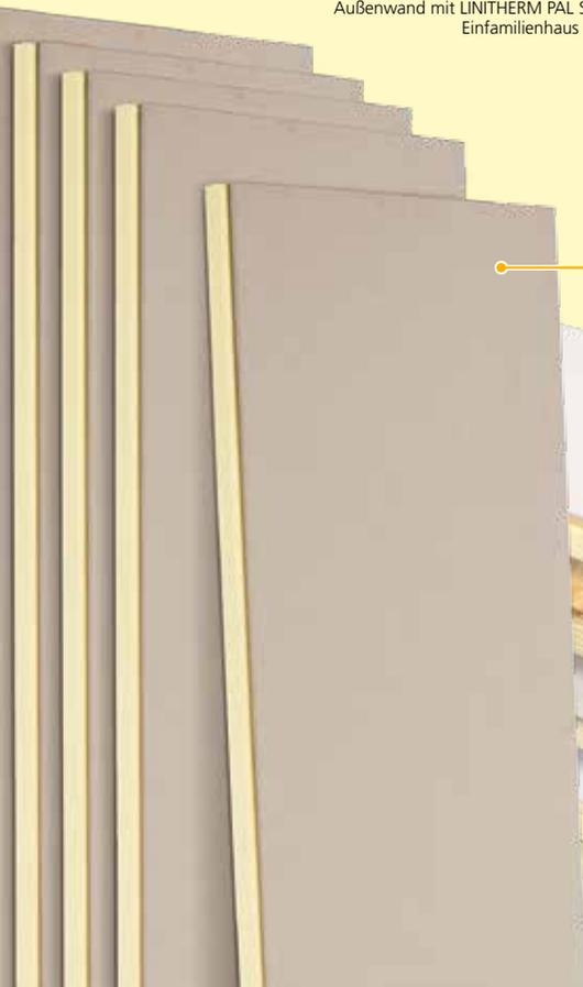
LINITHERM PAL SIL, Innendämmelement für Außenwände mit raumseitiger Silikatplatte, die als Feuchtepuffer wirkt und resistent gegen Schimmelpilze ist
